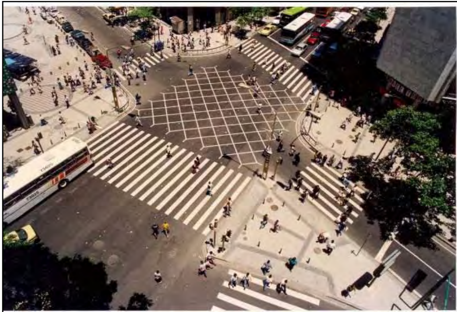
Figura 117: Cruzamento com a São José e a Nilo Peçanha, novas faixas de pedestres e criação de ilha viária. Fonte: Acervo do escritório Taulois & Taulois, 1994.
